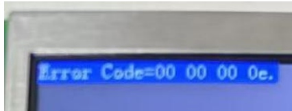
图 1 黑屏，左上角显示“Error code xxxx 000e”错误代码
